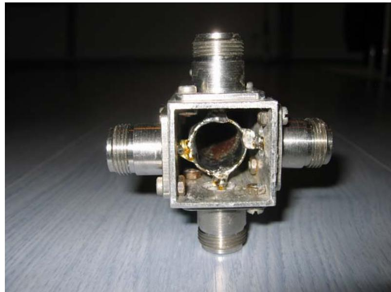
521mm. Montiramo konektore na profil i ubacimo bakrenu cijev u sredinu. Lemilicom veće snage zalemimo bakrenu cijev za srednje izvode koaxialnih konektora. Pažnju moramo обратити на то да nam je bakrena cijev točno u sredini profila, jednako udaljena od svih stijenki, te da nam je lemljivo izvedeno.
