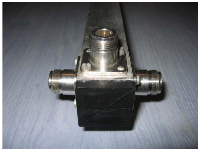
HRS-u br. 2, 3, 4. U nedostatku istoga dobro će poslužiti i obični SWR metar. Pripremimo 4 konektora sa ugrađenim 50 ohmskim otporima, iste spojimo na prilagodnu dionicu na stranu spajanja antenskog sistema. Na ulaznu antensku priključnicu spojimo SWR metar te izlaz iz predajnika. Ako je sve rađeno po navedenim mjerama, izmjereni SWR trebao bi biti gotovo jednak 1.
