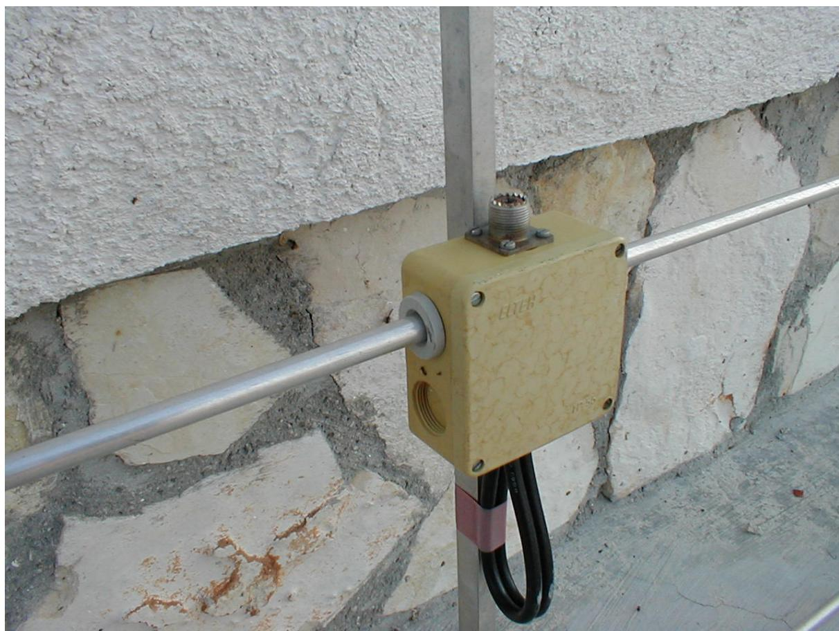
Svi elementi antene su izrađeni od aluminijskih cijevi promjera 10 mm uključujući i sam radijator. Raspored i dimenzije elemenata navedene su u tablici 2. Za izradu se mogu koristiti i aluminijске cijevi manjih promjera, ali sa promjenjenim dimenzijama koje možete pogledati na web stranicama Njemačkog autora DK7ZB ([www.qsl.net/dk7zb](http://www.qsl.net/dk7zb)).
