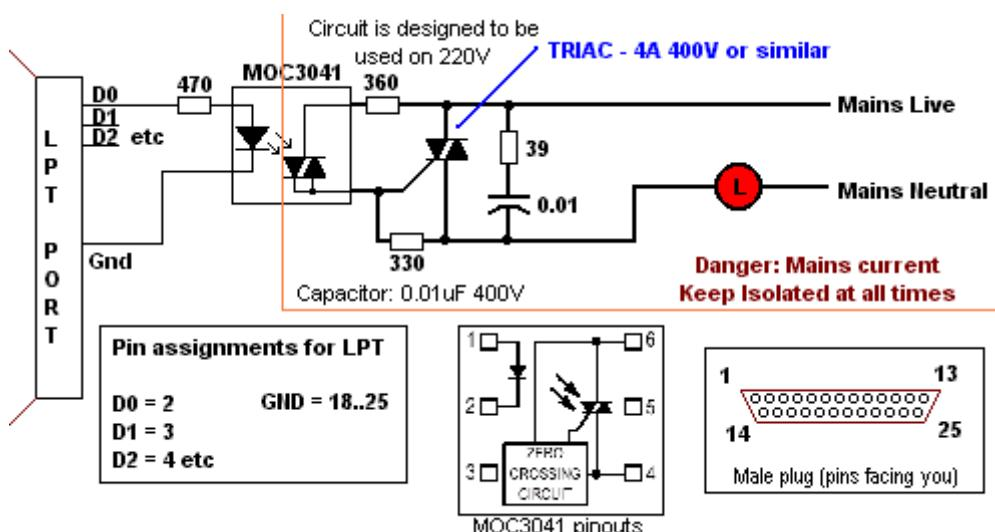
Napomena: Sklop za intenzitet svjetla unosi smetnje u gradsku mrežu. Takvi se skloovi komercijalno prodaju, ali se ne preporučuju za korištenje s žaruljama velikih snaga. Ovo se može izbjegić dodavanjem zavojnice, ali to tada dodatno komplikira sklop, čime se gubi sama ideja da se napravi što je moguće jednostavniji
