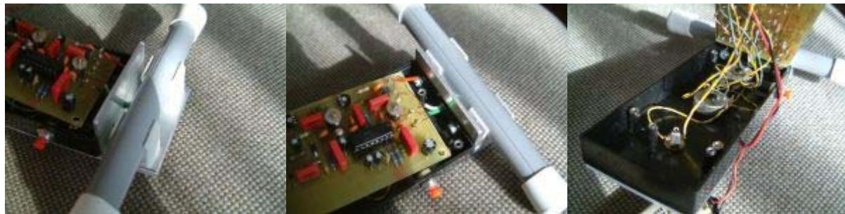
Vanjski dio goniometra čine sklopka za uključivanje i isključivanje (koja može biti izvedena i tako da se stereo utikač preuredi da radi kao sklopka kada se u njega uštekuju mono slušalice), stereo utikač za slušalice, tipkalo za određivanje smjera «lisice», te dva potenciometra: za namještanje frekvencije i pojačanja. Za razliku od starijih goniometara koji su attenuator imali izведен pomoću sklopke, na ovom se goniometru može podešavati stupanj atenuacije (prigušenja).
