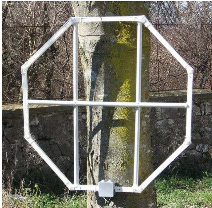
Octoloop antena (prilikom uporabe izbjegavati blizinu stabala, jer su dobri uzemljivači za EM signale)
